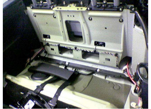
Banquette AR avec système d'arceaux extractibles à déclenchement pyrotechnique.
