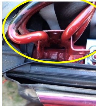
Passage ceinture avec pré-tensionneur, renforcé
