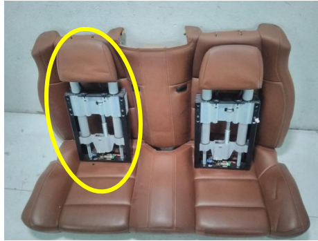
Banquette AR avec système d'arceaux extractibles à déclenchement pyrotechnique.
