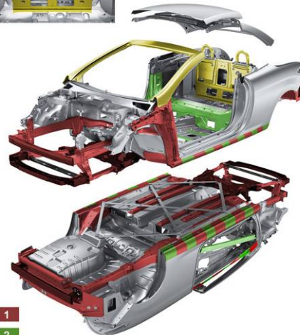
Vue éclatée des différents alliages et acier
