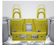
Passage ceinture avec pré-tensionneur, renforcé
